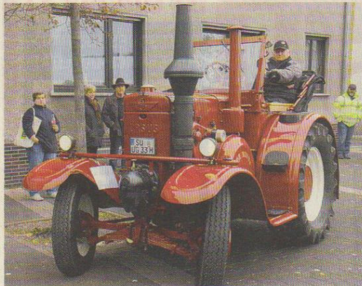
Satte 10,3 Liter Hubraum hat dieser polnische Ursus von 1949. Im Leerlauf wackelt das Cockpit rhythmisch zum Schlag der Zylinder.
